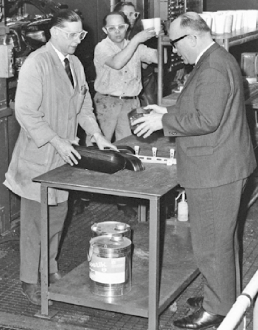
Abteilungsleiter Neugebauer und Meister Matzdorf an einer Rotationsanlage zur Fertigung von Armauflagen für die Türinnenverkleidung von VW 1300 und VW 1500, 1968
