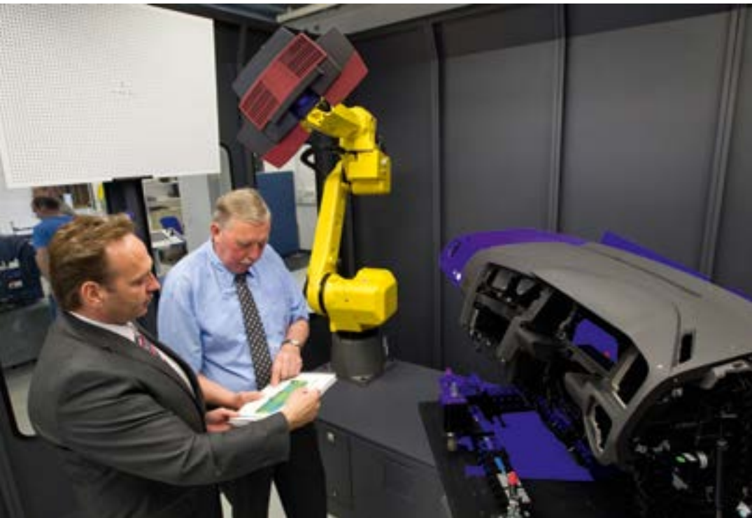
Analyse der Messergebnisse bei der Serienüberwachung von Instrumententafeln
