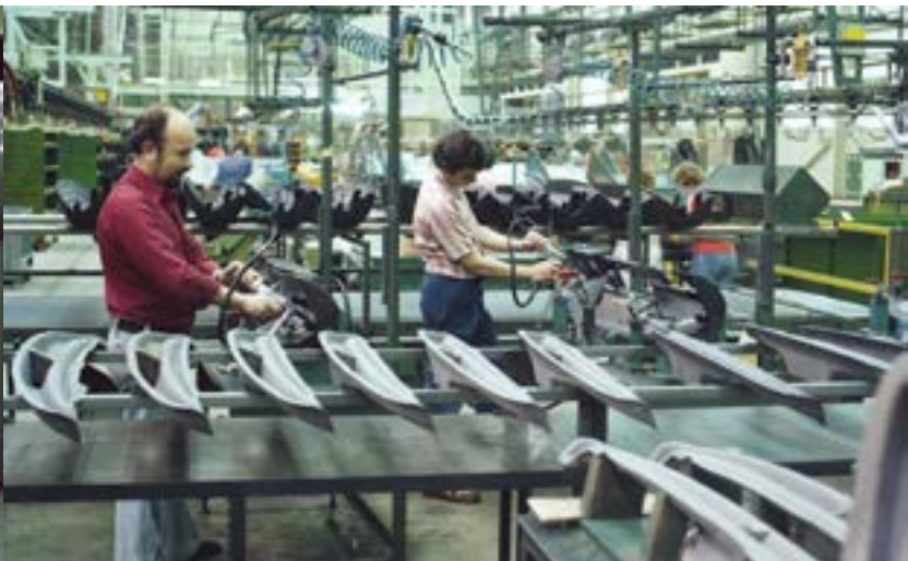
Montage Instrumententafel Golf 1 in der Halle 42, 1979
