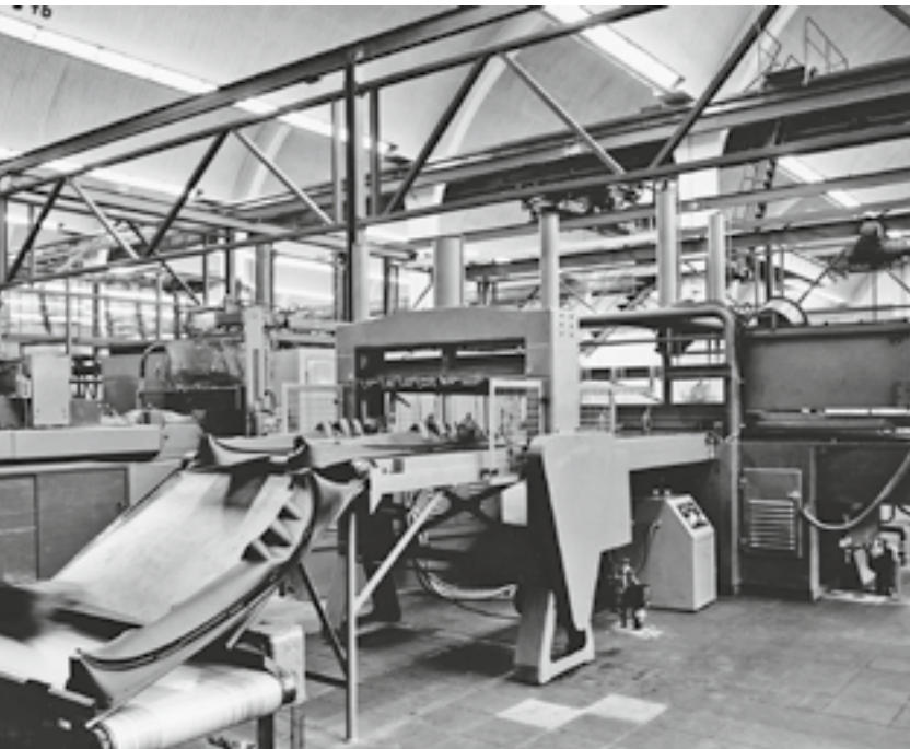
Tiefziehanlage zur Fertigung der Instrumententafel des VW 1500 in Halle 11, 1964
