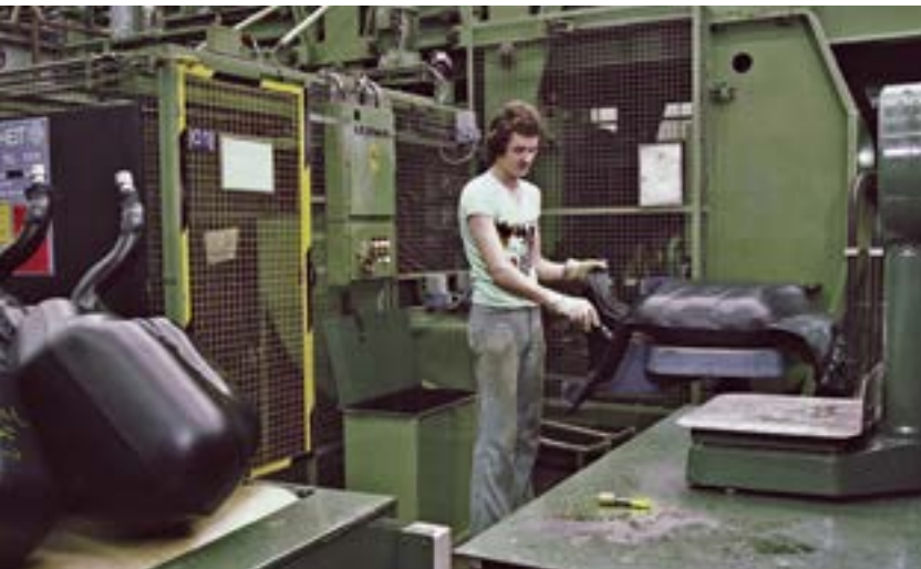
Herstellung des Kunststofftanks in der Halle 42, 1979
