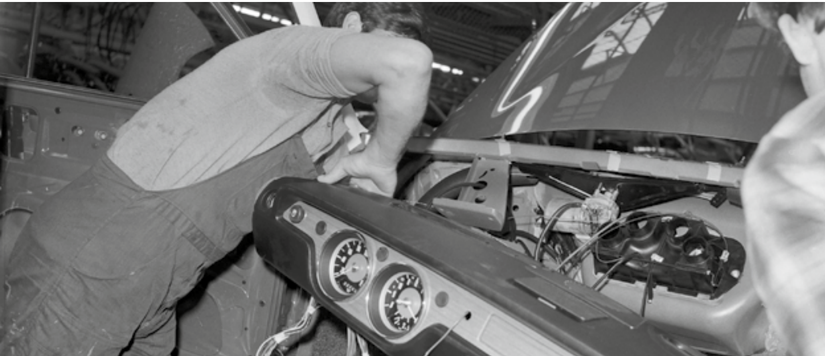
Einbau der Schalttafel beim VW 411, 1968
