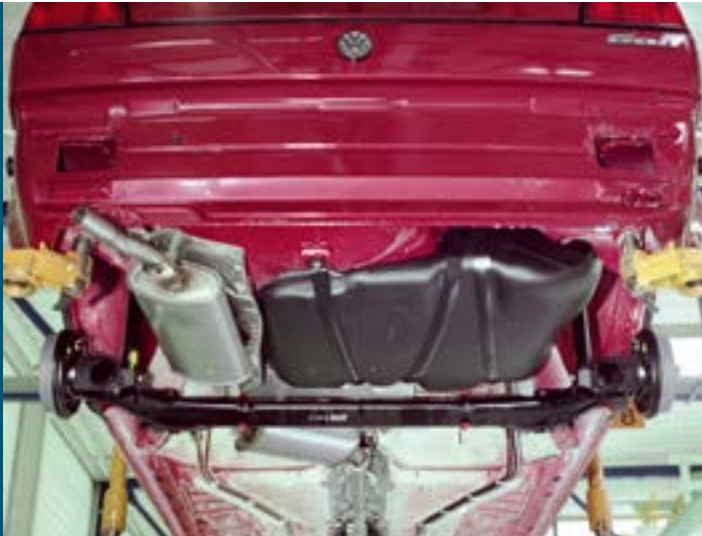
Golf-Montage in Halle 54, 1989. Hinterachse und Kunststofftank sind bereits montiert.
