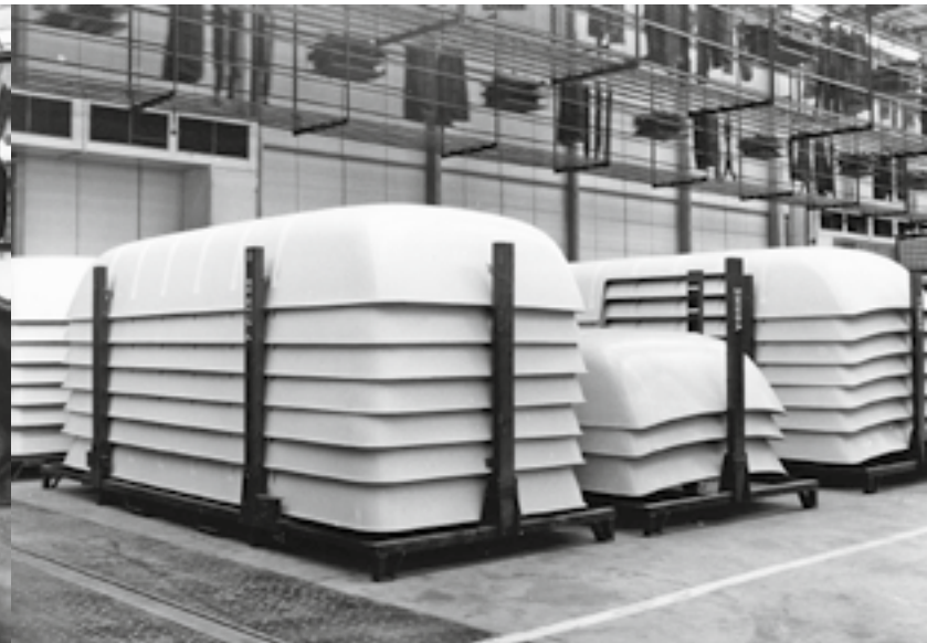
Hochdächer in Transportgestellen zum Versand ins Werk Hannover, 1968
