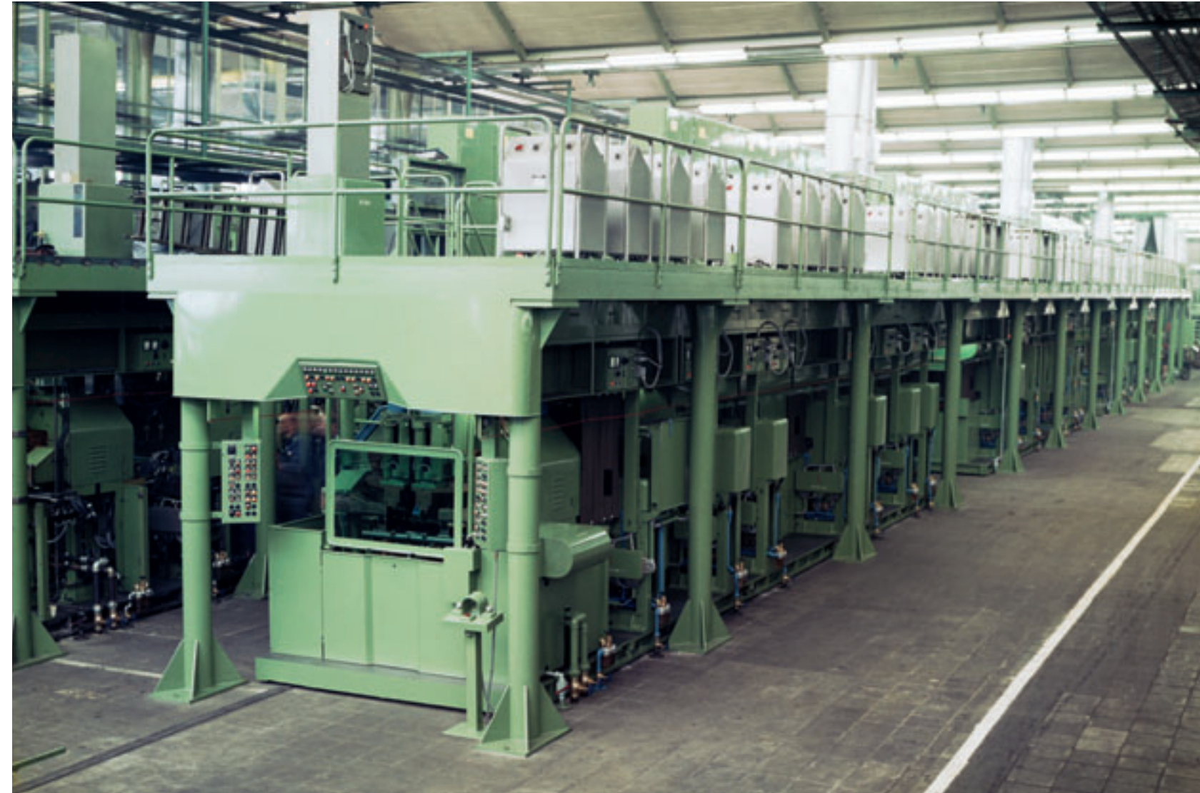
Schweißstraße für Vorderachskörper im Werk Braunschweig, 1965
