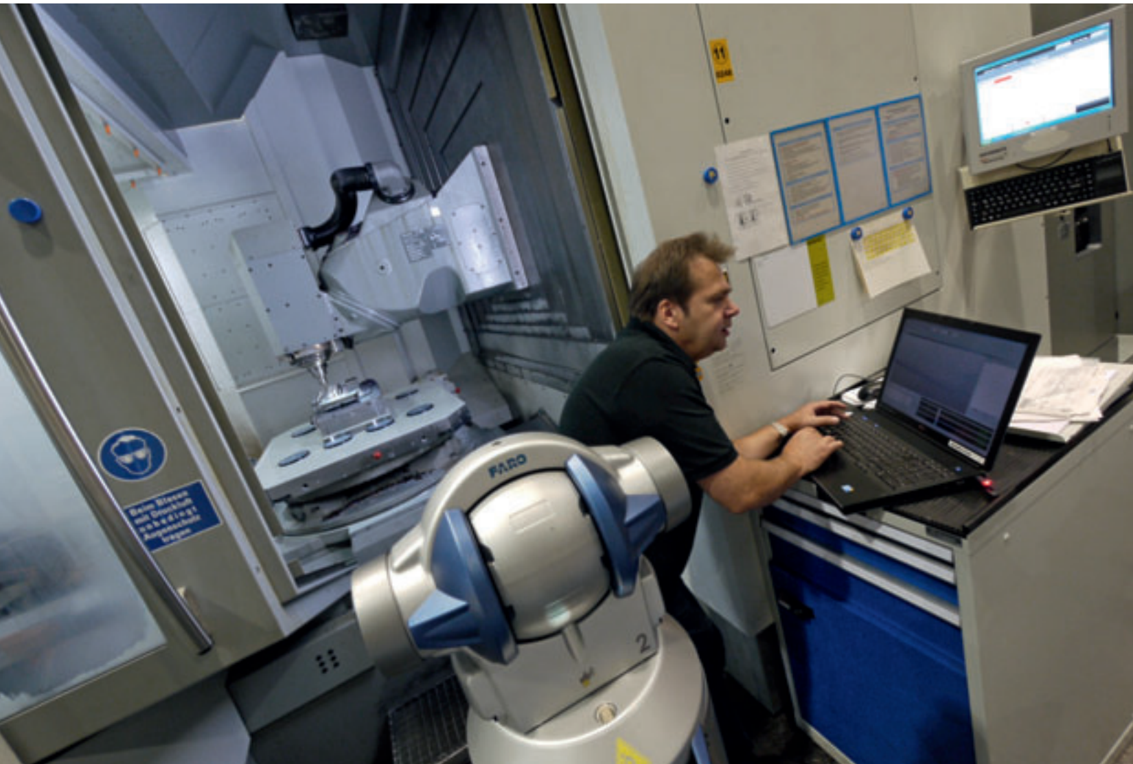
Laservermessung einer 5-Achs-Fräsmaschine
