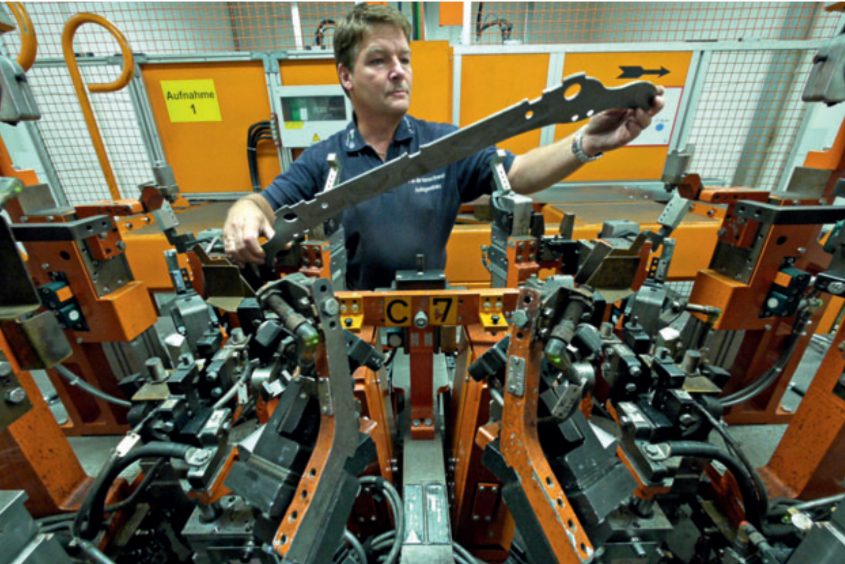
Überprüfung einer Spannvorrichtung für den Querträger eines Hilfsrahmens für den Audi A6
