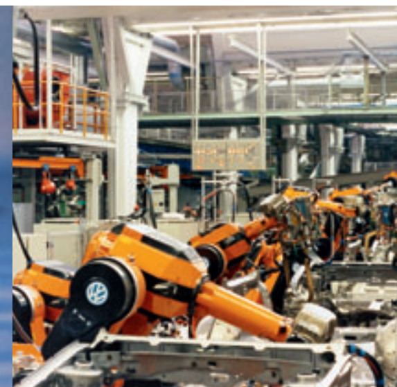
Schweißanlage des MWB für den Unterboden in Wolfsburg, um 1995
