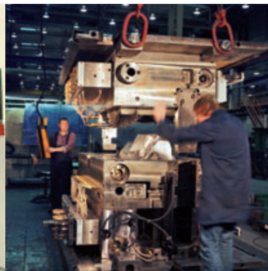
Montage eines Spritzgießwerkzeugs, um 1995
