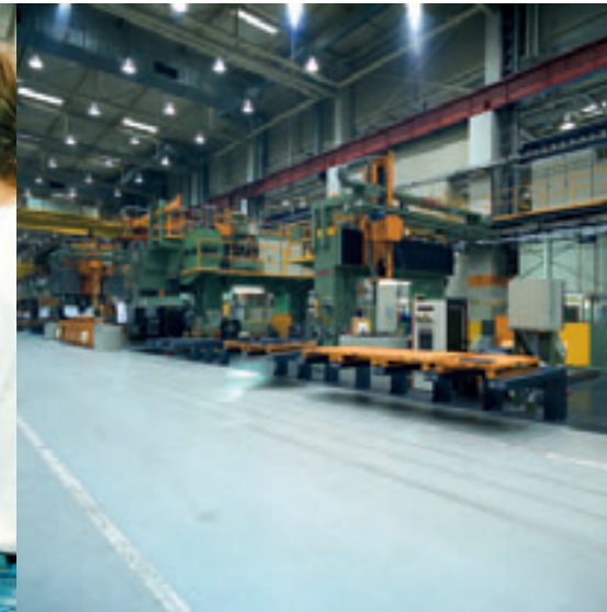
Fertigungszelle zur Bearbeitung von Großwerkstücken bis 50 Tonnen, um 1990
