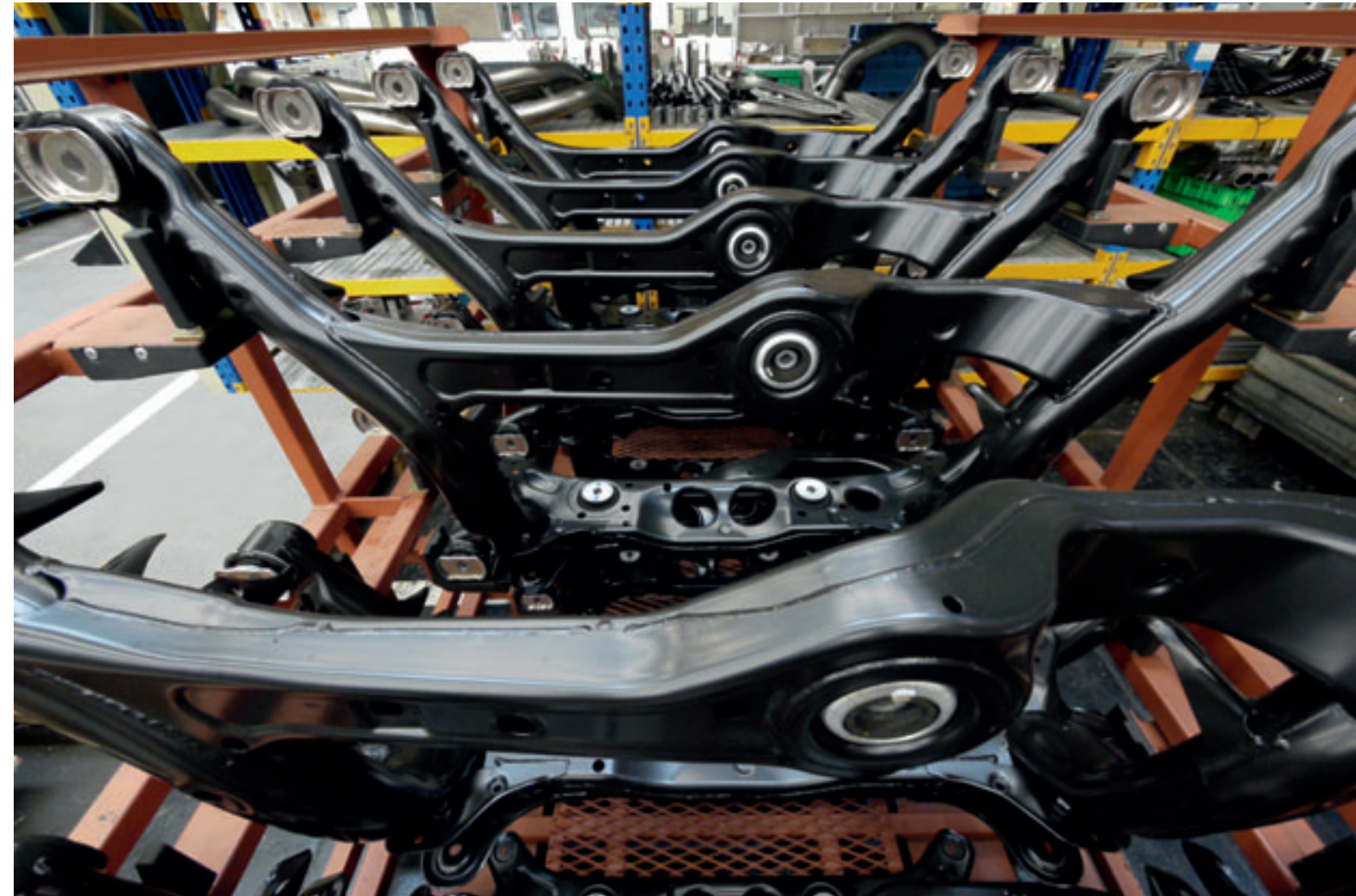
Hinterachshilfsrahmen für den neuen Audi A8 im Prototypenbau
