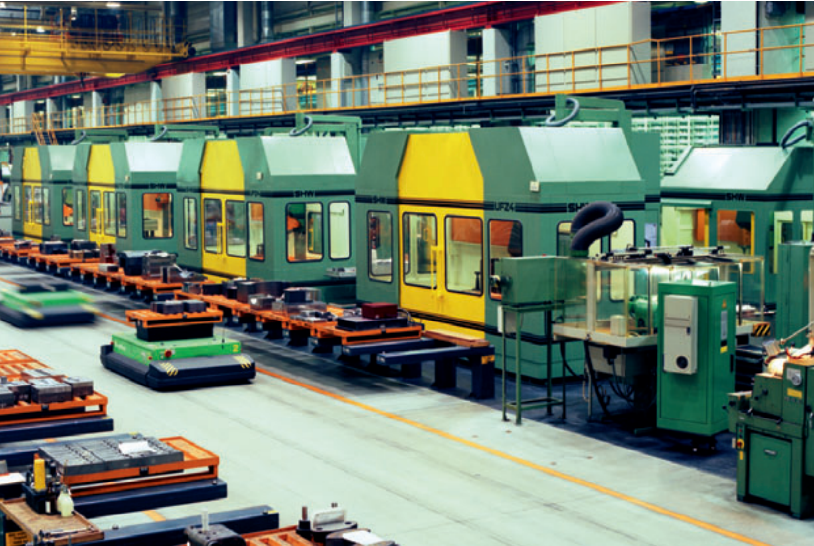
CNC-Bearbeitungszentren für Werkstücke mittlerer Größe, 1991
