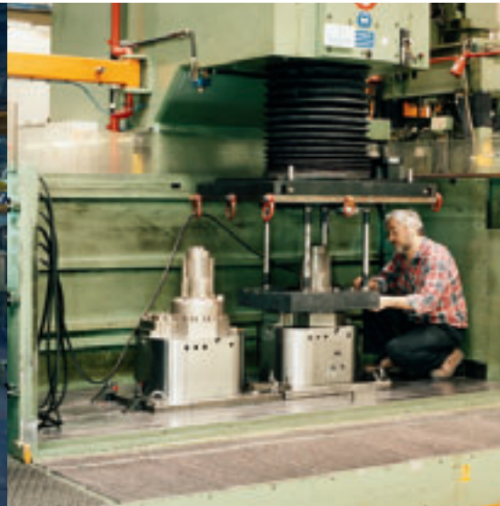
Senkerodieren eines AG4-Getriebekerns, 1987
