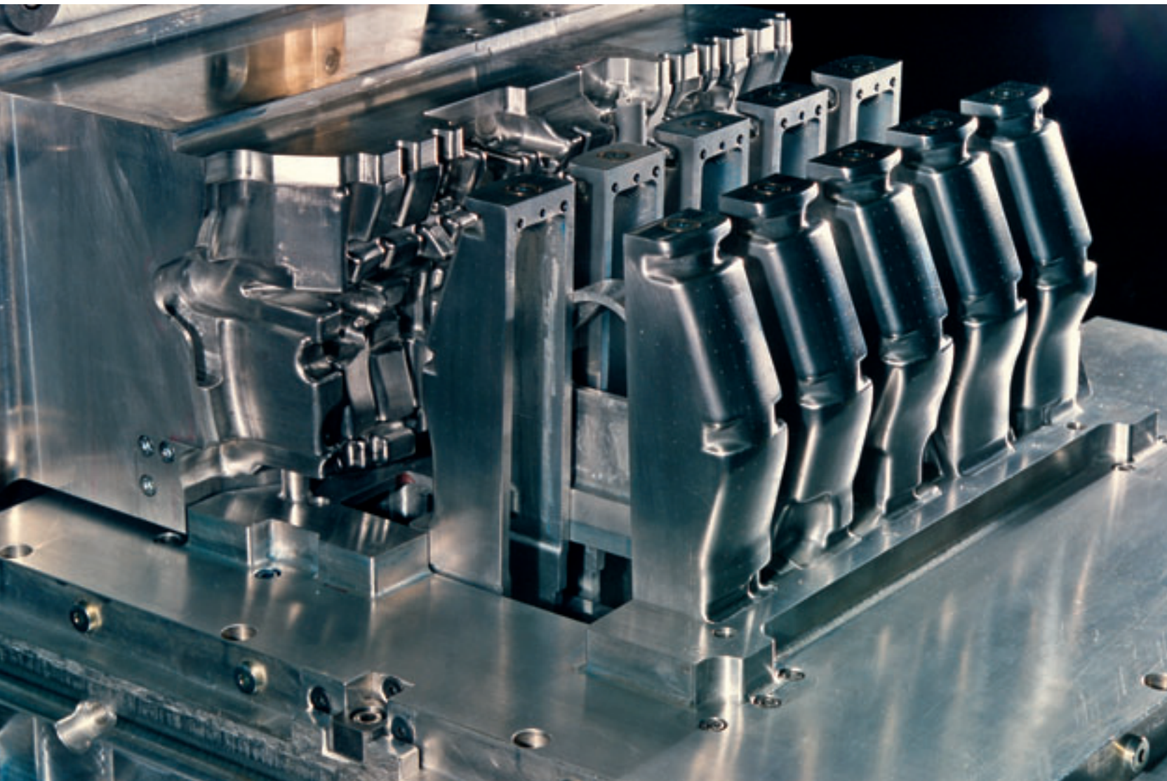
Lost-Foam-Versuchswerkzeug für ein Zylinderkurbelgehäuse, um 1997
