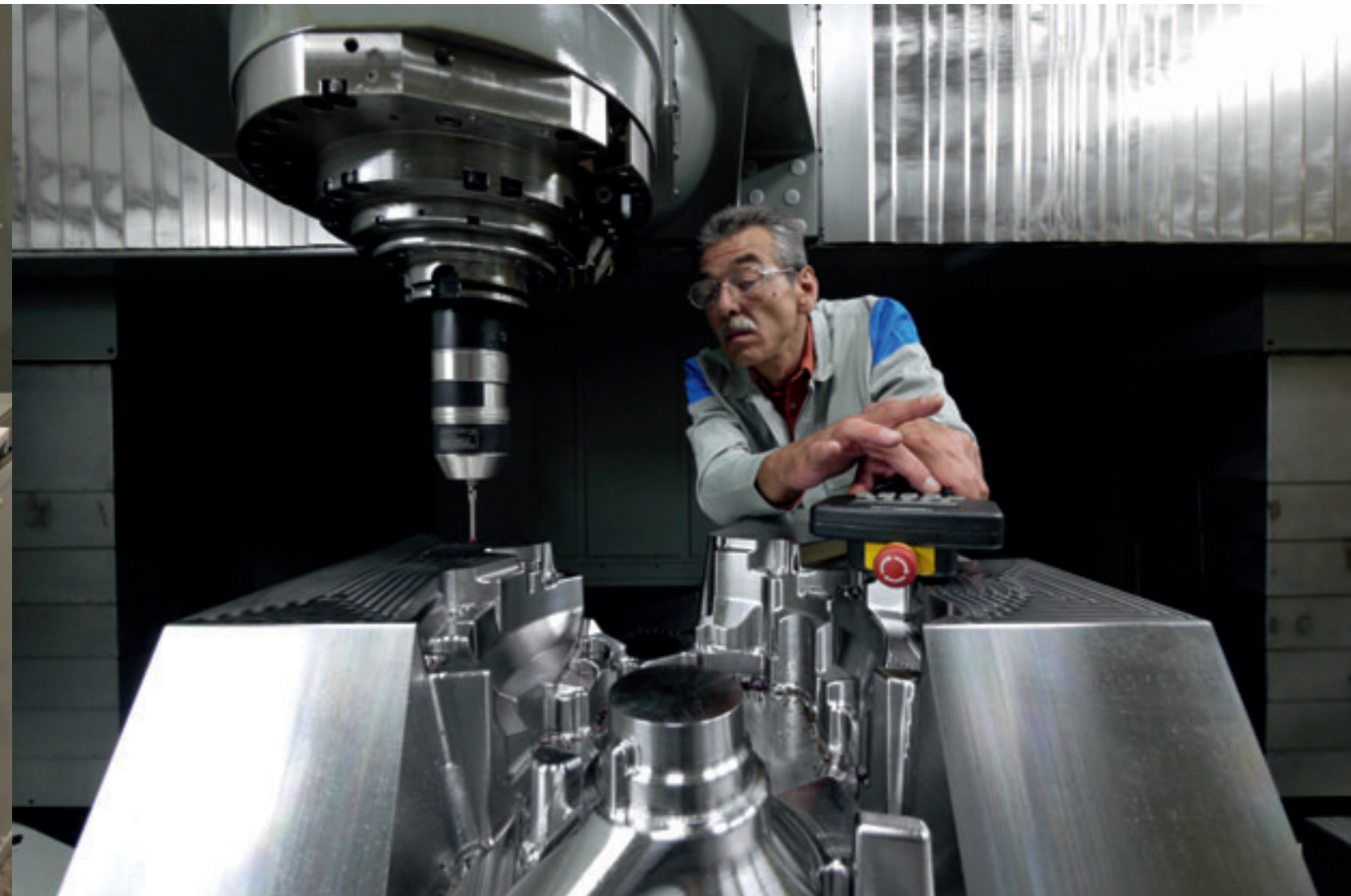
Zwischenkontrolle der Formteilgeometrie mit elektronischem Messtaster auf der Werkzeugmaschine
