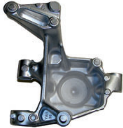
Hinterachs-Radträger 4-Motion aus Aluminium für die Passat-Klasse im CPC-Gießverfahren
