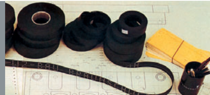
Lochstreifen für NC-Maschinen, um 1978
