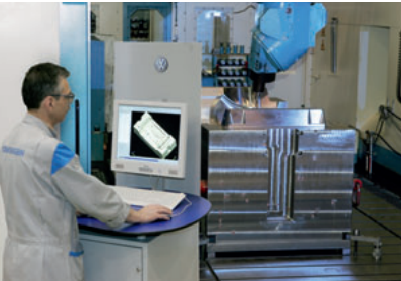
Computergestütztes Fräsen eines Stoßfängers, 2005
