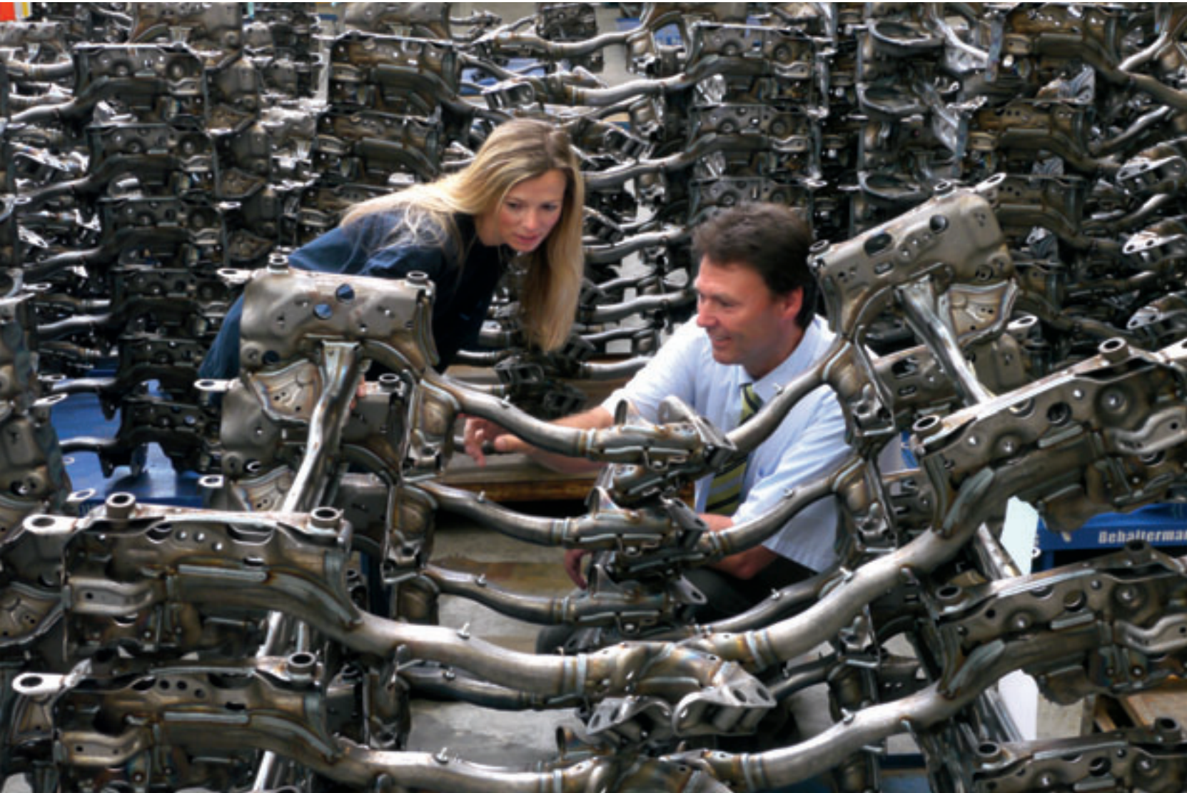
Überprüfung der Schweißnahtqualität an einem Hilfsrahmen für den Audi A8
