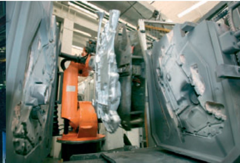
Gießen von Fahrwerkteilen im Leichtmetallzentrum in Braunschweig, 2005
