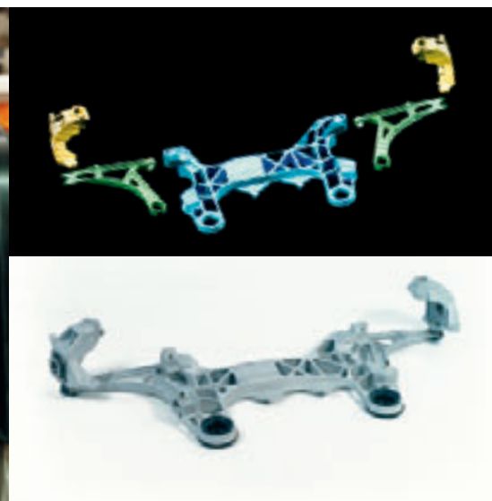
Erster Prototyp: Hilfsrahmen aus Leichtmetall, um 1995
