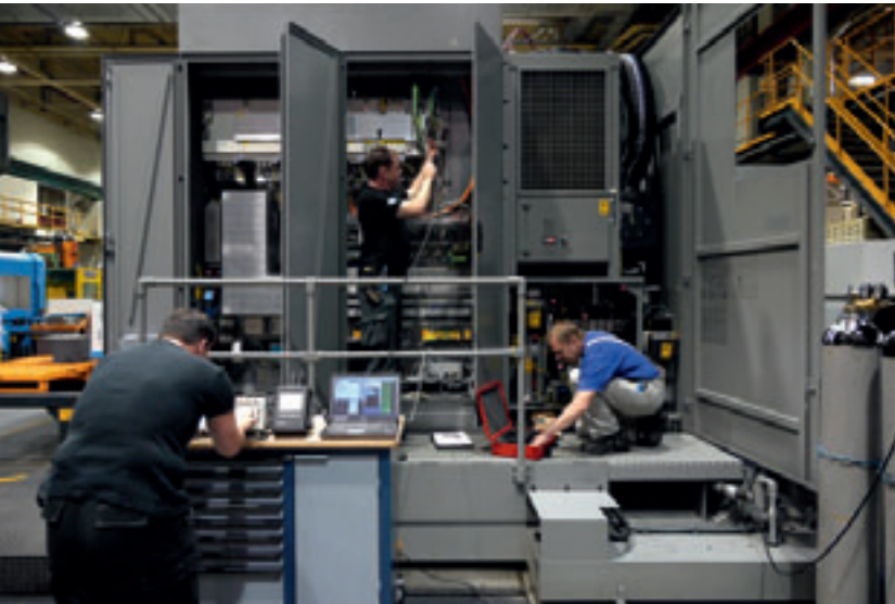
Turnusmäßige Wartung („Boxenstopp“) der Werkzeugmaschinen durch den „Service Maschinenzentrale“
