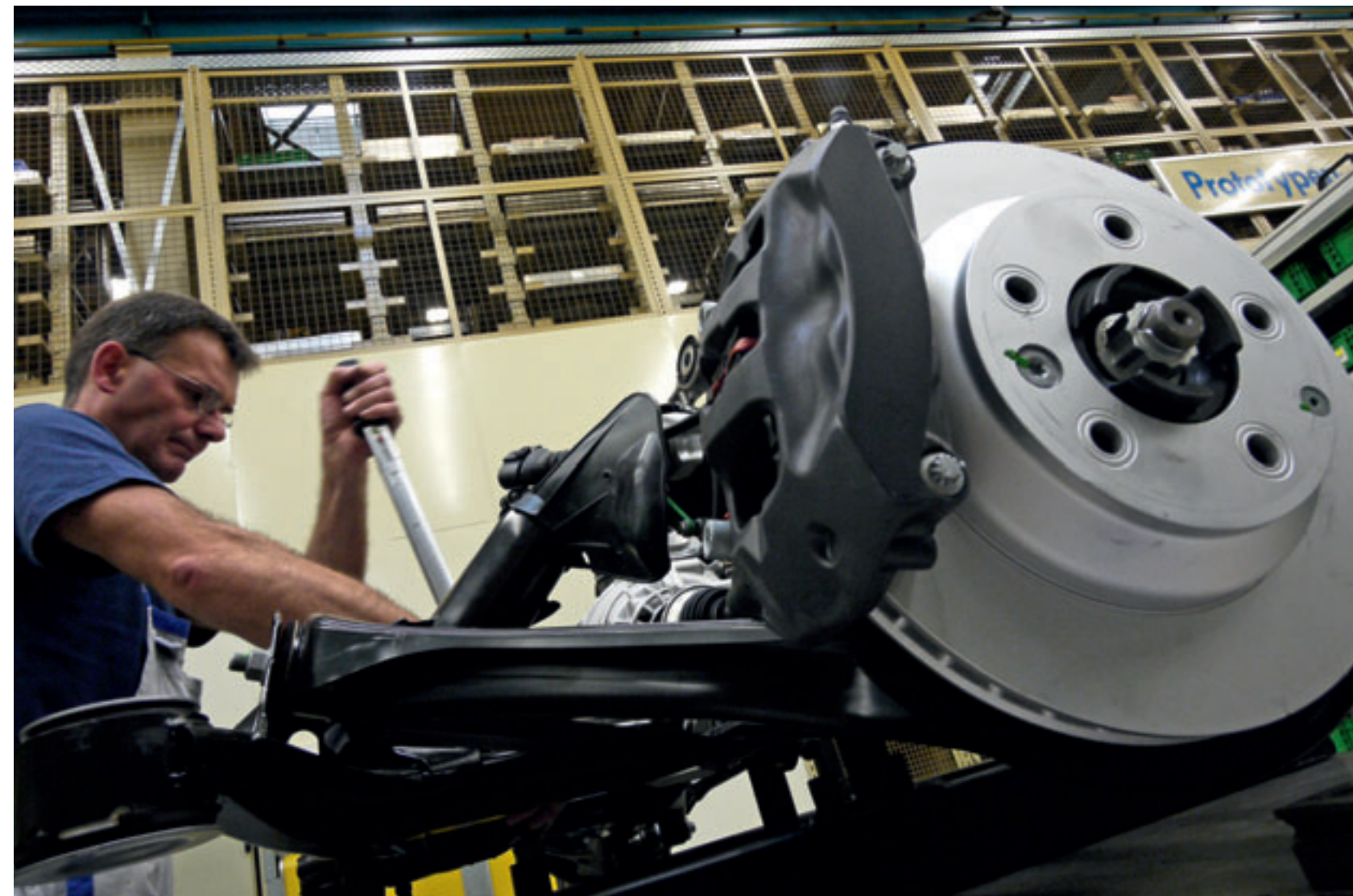
Verschrauben einer Gelenkwelle an das Getriebe einer Touareg Hinterachse im Prototypenbau Fahrwerk
