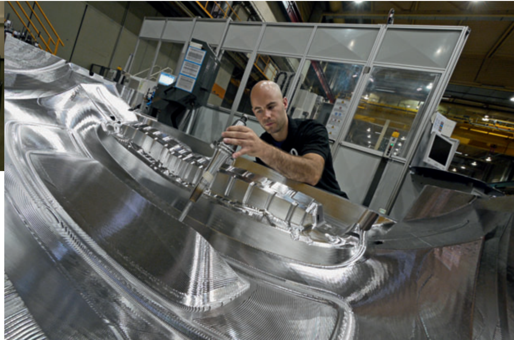
Optische Überprüfung eines erstmalig eingesetzten Fräswerkzeugs zur Vermeidung von Beschädigungen an der sonstigen Kontur
