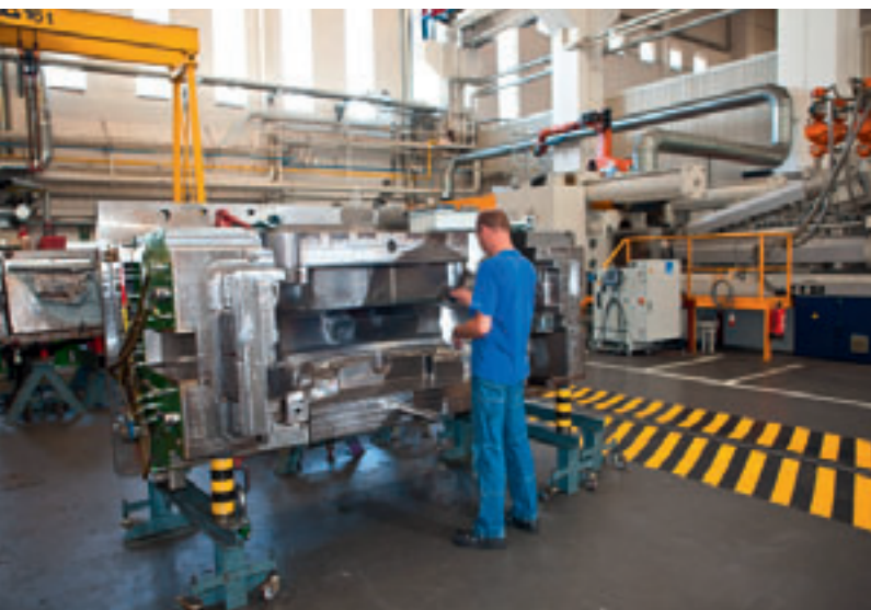
Instandsetzung eines Stoßfänger-Werkzeugs in Halle 17 im Werk Wolfsburg; im Hintergrund die 4.000-Tonnen-Spritzgießmaschine
