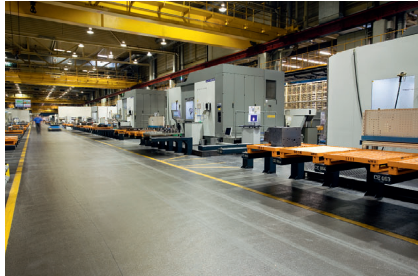
Bearbeitungsmaschinen in der Maschinenzentrale; im Hintergrund links einer der Informationsbildschirme zur Darstellung der aktuellen Kennzahlen der Maschinendatenerfassung MDE
