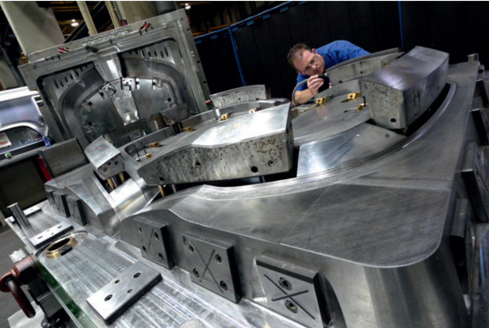
Einarbeiten von Segmenten eines Radabdeckungswerkzeugs
