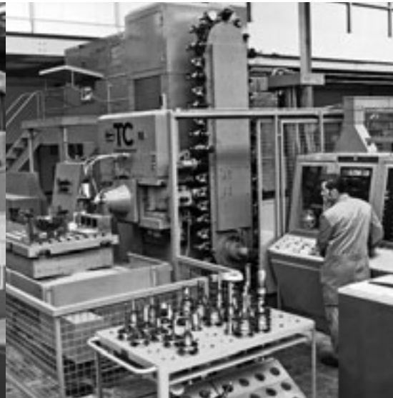
NC-gesteuertes Bearbeitungszentrum im Werkzeugbau, 1972
