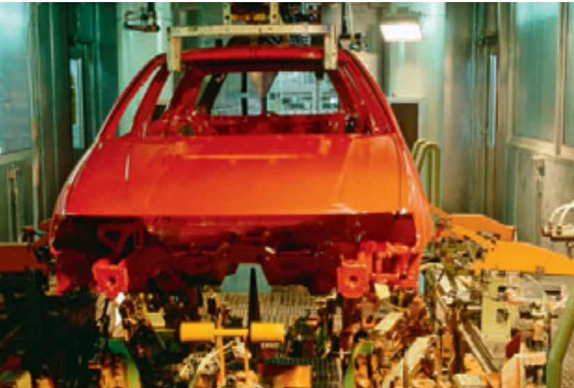
Wachsflutanlage zur Hohlraumkonservierung, Werk Wolfsburg, um 1995
