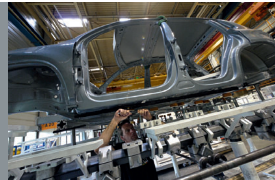
Einrichten einer Flutmechanik zur Hohlraumkonservierung
