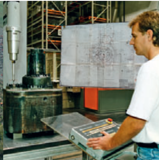
Messen mit der taktilen Messmaschine, um 1990
