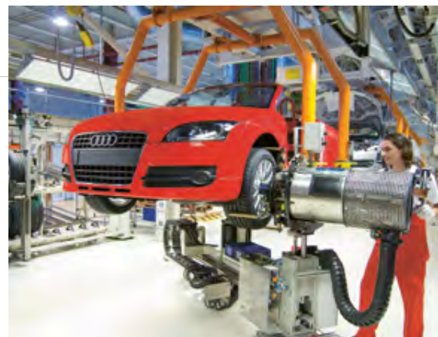
MONTAGE DES TT IN GYÖR
