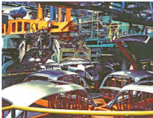
EIN WICHTIGER AUTOMATISIERUNGSSCHRITT: DIE TRANSFERSTRASSE
