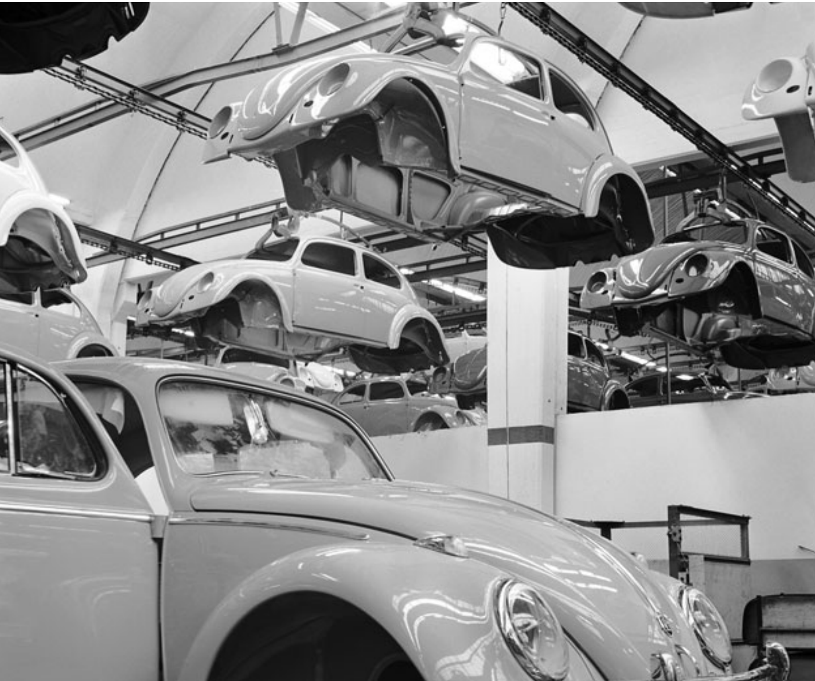
Karosserien an Kettenförderern in der Endmontage der Halle 12, 1961
