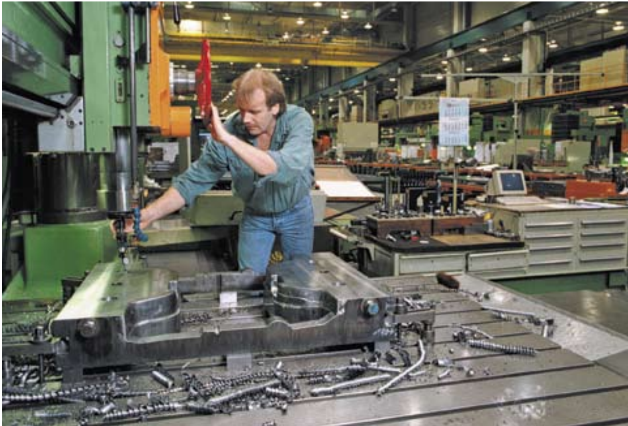
Kopierfräsen von Kokillen im Maschinen- und Werkzeugbau, 1998
