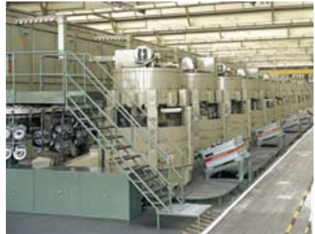
Bullard Automaten zur mechanischen Bearbeitung von Bremsscheiben, 1970
