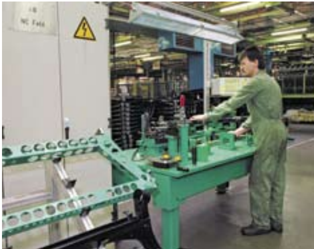
Vermessen von Hinterachsschweißkörpern, 1998
