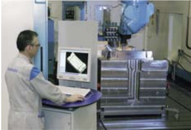
Computergestütztes Fräsen eines Stoßfängers, 2005
