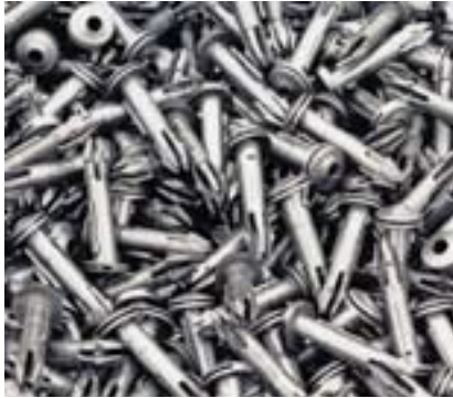
Führungsteile für die Halterung von Kopfstützen, 1987
