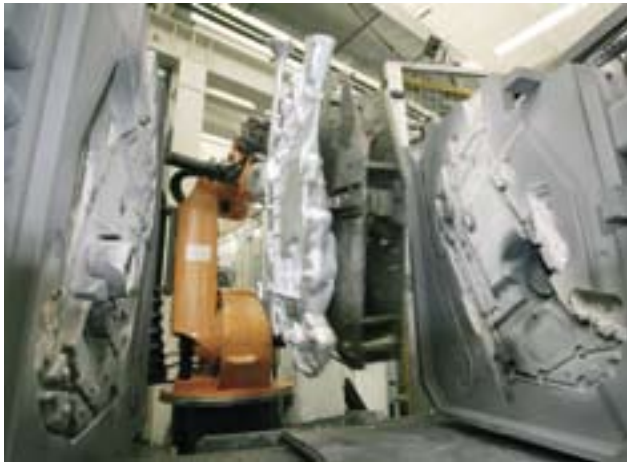
Entnahme einer gegossenen Leichtmetalltraverse aus einer Schwerkraftkokille, 2005
