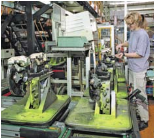
Montage von Schwenklagern, 1993
