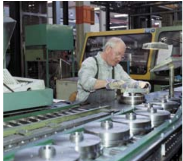
Qualitätskontrolle von Bremstrommeln, 1993
