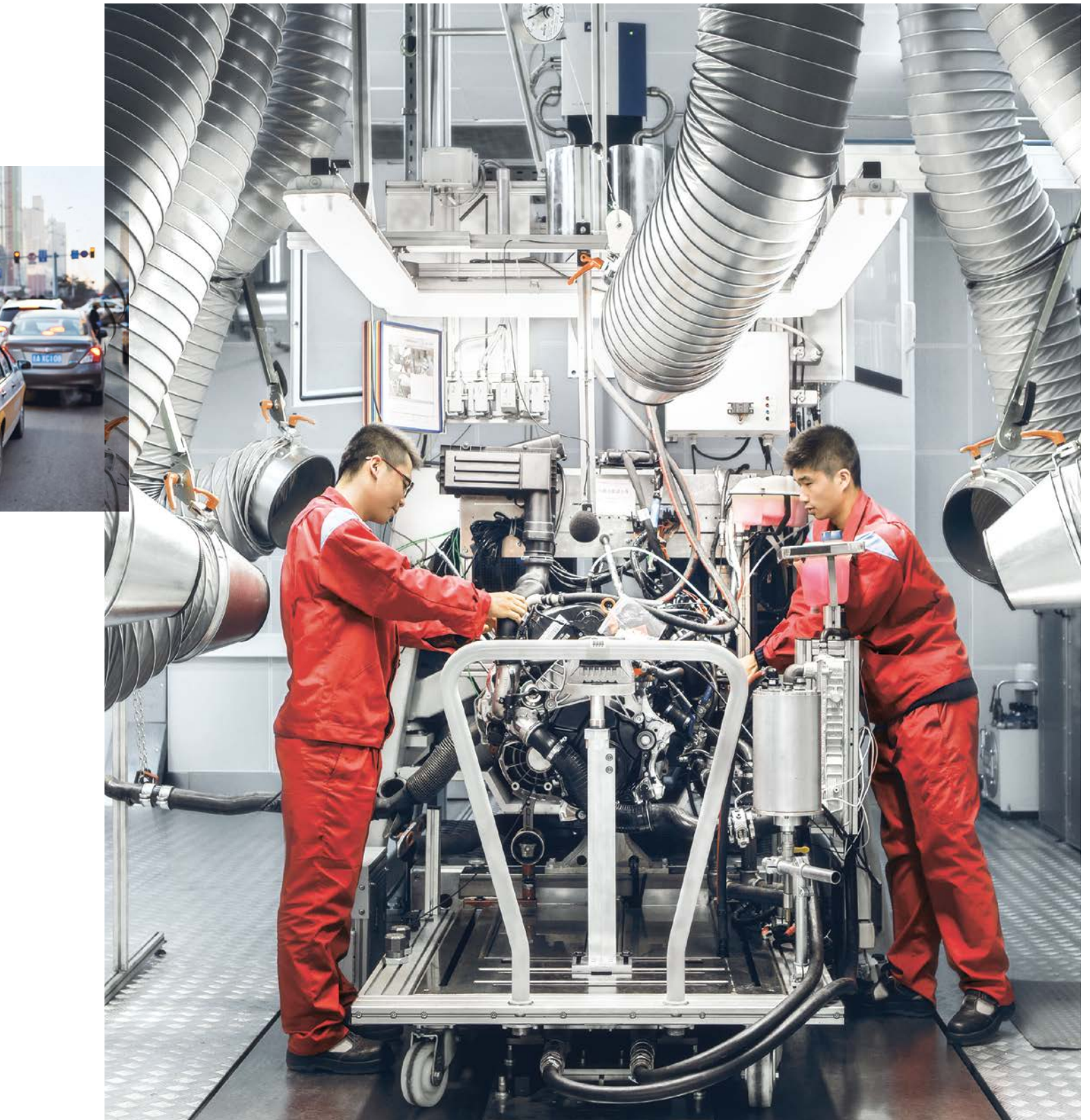
Prüfen und Testen gehört zur täglichen Routine im neuen Motorenwerk von Volkswagen FAW Engine, zum Beispiel auf dem Heißtest-Prüfstand.
