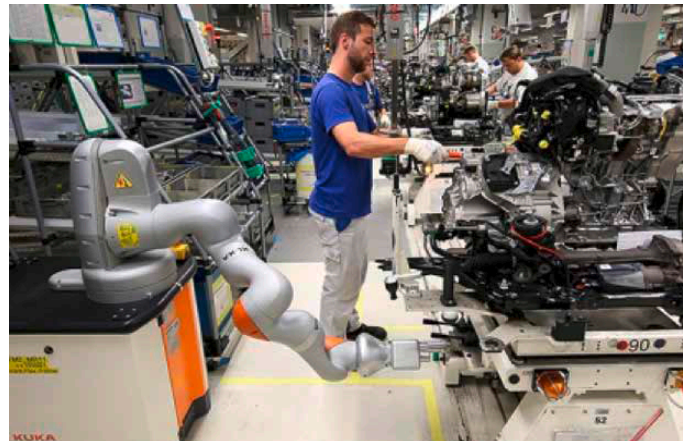
Der Roboter entlastet den Menschen bei ergonomisch ungünstigen Tätigkeiten.
