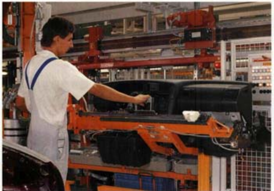
Einsatz der Modulbauweise bei der Cockpit-Montage
