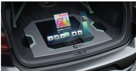
Frei schwebende Bedienelemente, über die das High-End-Soundsystem gesteuert wird: Im Kofferraum wurde das von der Konzern Komponente entwickelte kompakte Hologramm-Modul verbaut.
