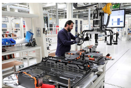
Neuausrichtung steigert Effizienz und sichert langfristig Arbeitsplätze: In Braunschweig werden unter anderem die Batteriesysteme für den e-Golf 1 gefertigt.
